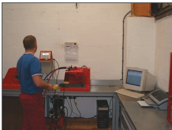
Kalibracja hydraulicznego klucza dynamometrycznego
