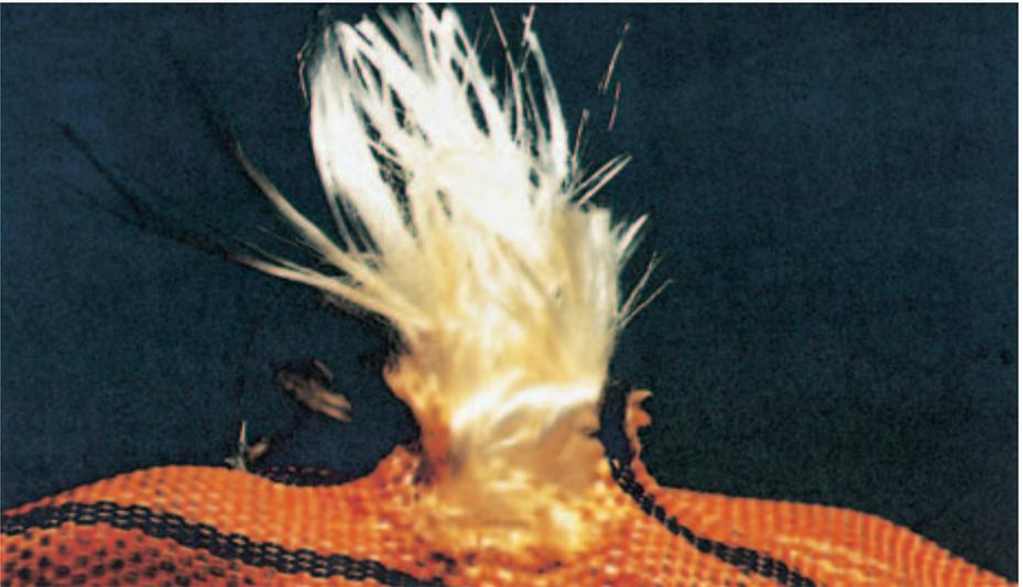
*Bild 23-16: Durch Wärmeeinfluss zerstörte Ummantelung*
