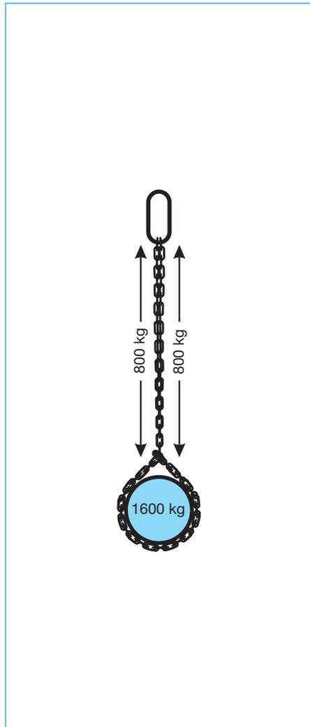
*Bild 14-15: Wird eine endlose Kette im Hängegang knickfrei um die Last gelegt und unmittelbar in den Kranhaken gehängt, darf wegen der Biegebeanspruchung im Kranhaken nur 80 % des Doppelstranges genutzt werden. Neigungswinkel bis 7° brauchen nicht zusätzlich berücksichtigt zu werden*
