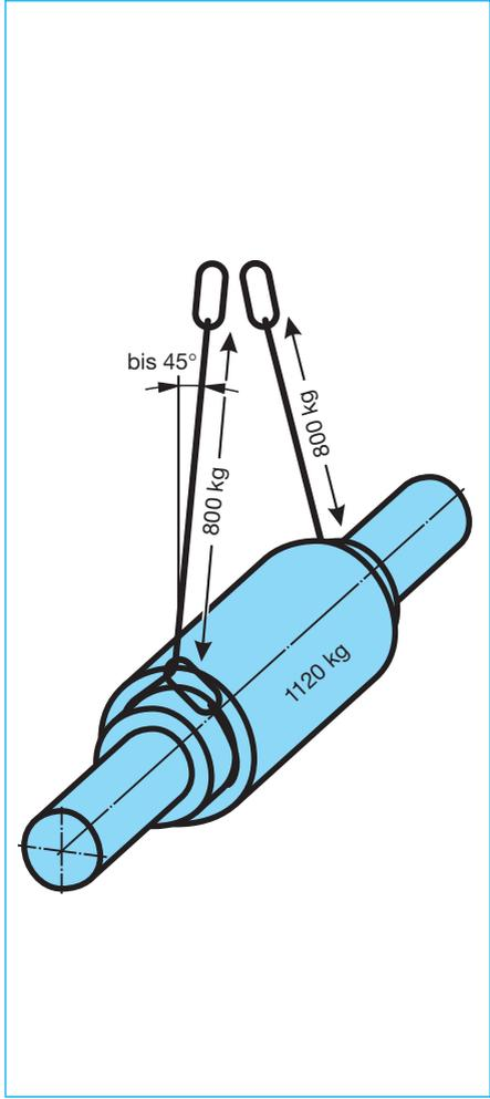
Bild 14-13: Wird eine Last mit einer Kranzkette, deren beide Enden an einem gemeinsamen Ring befestigt sind, so angeschlagen, dass die Kette im Hängegang knickfrei um die Last liegt und der Neigungswinkel vernachlässigt werden kann, darf jeder Strang als voll tragend angesehen werden. Bei Abweichungen bis 7° darf dies unberücksichtigt bleiben
