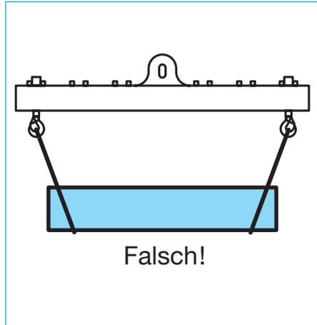
*Bild 15-2: Außermittiges Anschlagen der Last an Traversen. Die Traverse hängt schief, die Last kann aus den Anschlagmitteln rutschen. Die Aufhängung der Traverse wird einseitig beansprucht*
