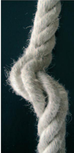
*Bild 23-9: Wärmeeinfluss hat eine Litze zerstört*
