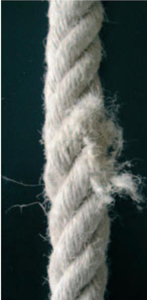
*Bild 23-8: Durch Klanke zerstörter Litzenverbund*
