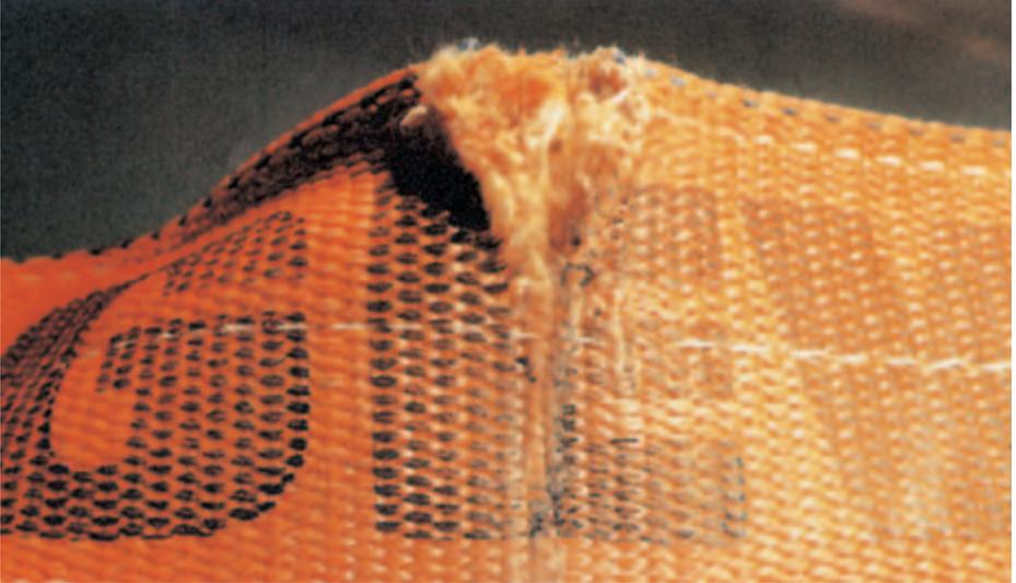
*Bild 23-15: Durch Schnitte beschädigte Ummantelung und Einlage einer Rundschlinge*
