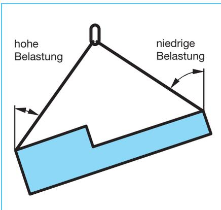
Zur Vermeidung einer Überlastung des stärker belasteten Stranges darf nur ein Strang als tragend angenommen werden: Die Anschlagmittel müssen daher so ausgewählt werden, als ob die Last nur an einem Strang angehängt wäre.
