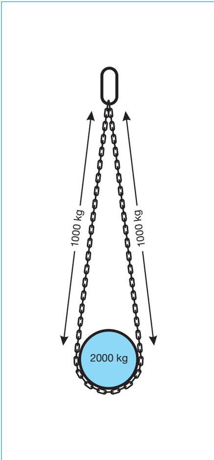
Bild 14-14: Wird eine Kranzkette im Schnürgang um die Last gelegt, muss die Tragfähigkeit wegen der Biegebeanspruchung im Schnürpunkt auf 80 % der Tragfähigkeit des Doppelstranges verringert werden
