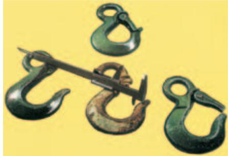
*Bild 23-21: Der am gereckten Strang tiefer hängende Haken zeigt, dass der ganze Kettenstrang ausgetauscht werden muss. Die Maulöffnung ist um 10 % erweitert, die Klappe schließt nicht mehr*
