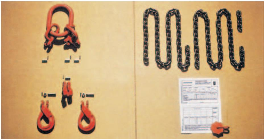
Für die Güteklasse 8 gibt es Bauteilserien, die eine eindeutige Zuordnung von Ketten-Nennstärke und Bauteil mit gleicher Tragfähigkeit gewährleisten. Die Öffnung am Bauteil ist zu schmal für eine zu dicke Kette, der Bolzen zu dick für eine zu dünne Kette.
