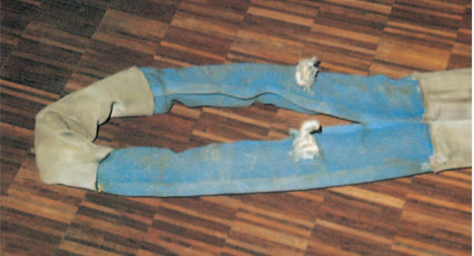
*Bild 23-19: Die Einlage einer Rundschlinge besteht meist aus einer einzelnen Kardeele, die mindestens 11-mal umläuft. Wird diese nur einmal durchgeschnitten, ist der innere Verbund der Rundschlinge durch Reibung nicht mehr gegeben!*
