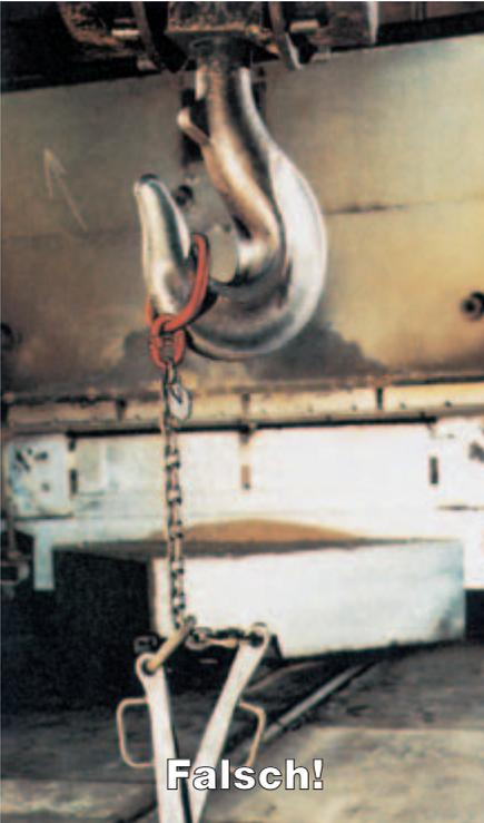
*Bild 22-2: Haken ist in eine zu kleine Öse eingehängt. Haken und Öse werden verbogen. Außerdem besteht die Gefahr des unbeabsichtigten Aushängens.*
