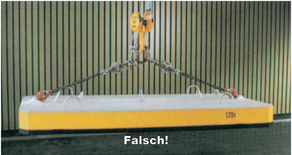
*Bild 14-3: Im Einzelstrang werden über 2,5 t gemessen, obwohl das Gewicht der Last nur 1,75 t beträgt*
