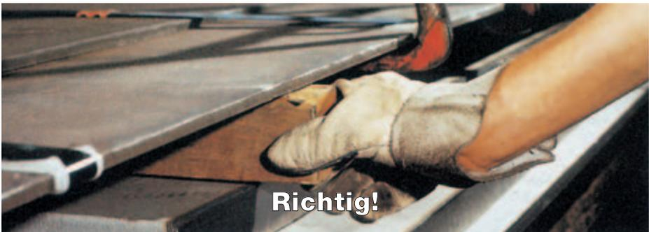
darf man sich nie zwischen der bewegten Last und festen Teilen aufhalten. Denn auch in einer von Hand in Bewegung gebrachten Last steckt so viel Energie, dass die Last nicht auf der Stelle durch Körperkraft abgestoppt werden kann.
