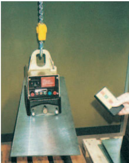
Kraftschlüssig angeschlagene Lasten dürfen nie über Personen hinweggeführt werden. Blechplatten segeln jedoch und andere Werkstücke können durch Anstoßen oder anschließendes Abgleiten von der Maschine den Maschinenbeschicker verletzen.
