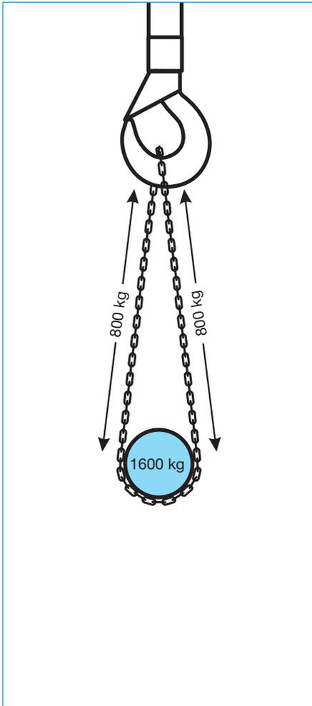
*Bild 14-16: Wird eine endlose Kette im Schnürgang um die Last gelegt und unmittelbar in den Kranhaken gehängt, muss die Tragfähigkeit wegen der Biegebeanspruchung im Schnürpunkt und im Kranhaken auf 80 % der Tragfähigkeit des Doppelstranges verringert werden*
