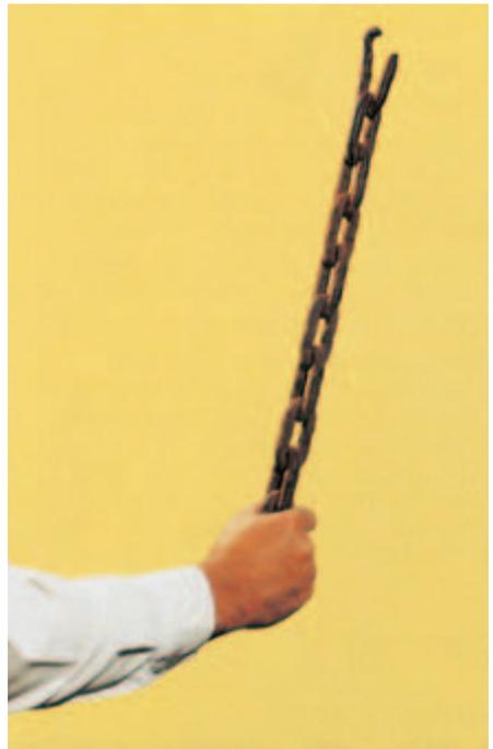
Bild 23-12: Die Kette ist ablegereif, wenn ein oder mehrere Glieder außen um je 3 % gelängt sind. Dies entspricht einer inneren Längung von 5 %
